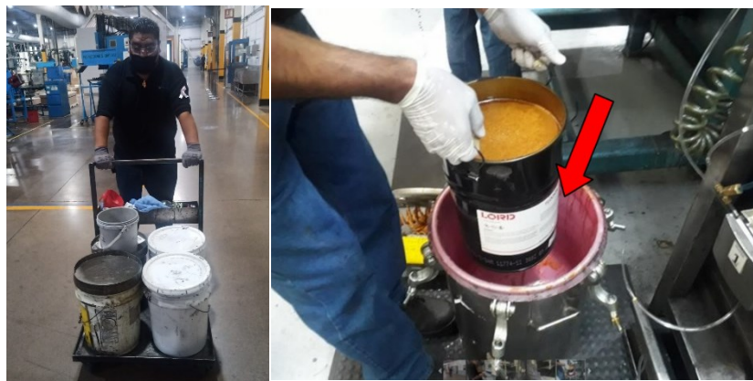
Ilustración 56 Cambio de coating y apagado de la cabina del plasma Cooper Standard. Fuente: Elaboración propia, 2022
