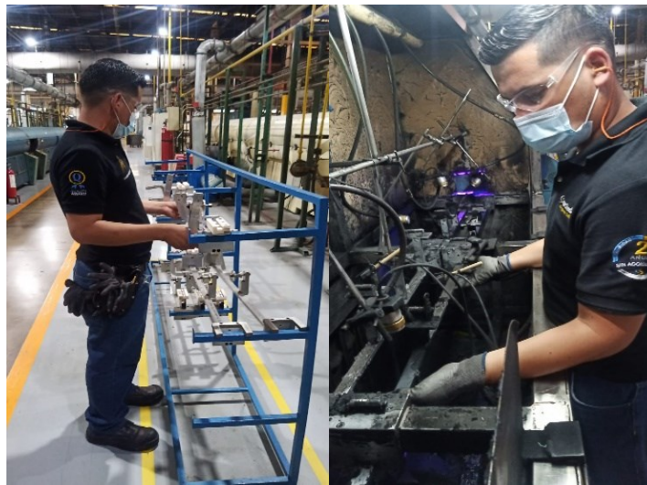
Ilustración 54 Cambio de guía Apagado de la cabina del plasma Cooper Standard. Fuente: Elaboración propia, 2022
