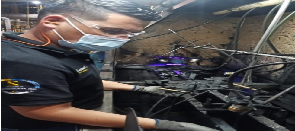
Ilustración 57 Colocación de pistolas de coating. Cooper Standard. Fuente: Elaboración propia, 2022
