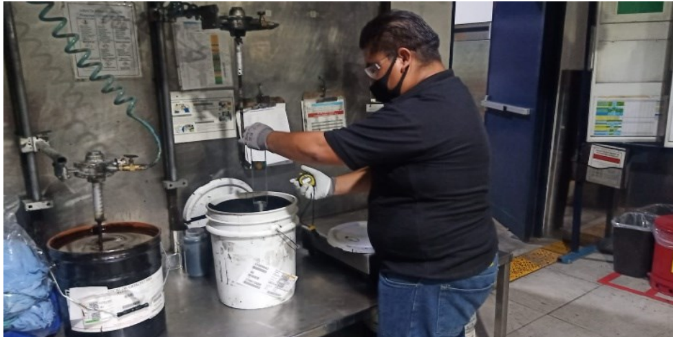
Ilustración 120 Chequeo de viscosidad del coating Cooper Standard. Fuente: Elaboración propia, 2022
