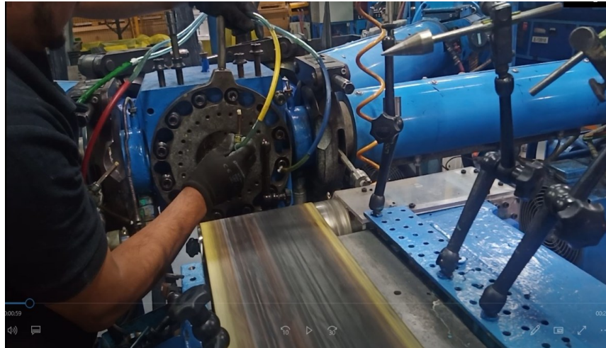
Ilustración 78 Colocación de mangueras inyectoras de aire Cooper Standard. Fuente: Elaboración propia, 2022
