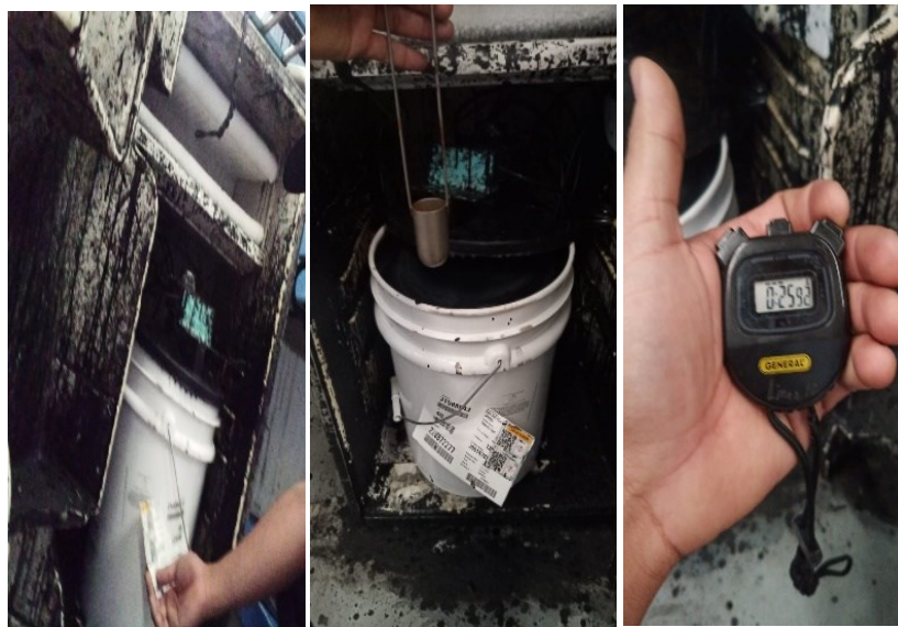
Ilustración 58 Revisión de parámetros del coating Cooper Standard. Fuente: Elaboración propia, 2022
