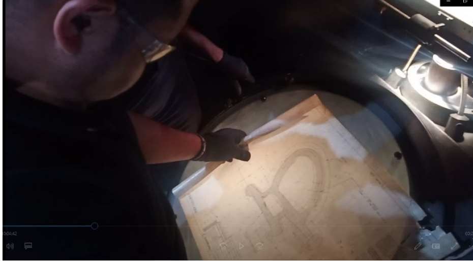
Ilustración 86 Chequeo de condición del perfil en comparador Cooper Standard. Fuente: Elaboración propia, 2022
