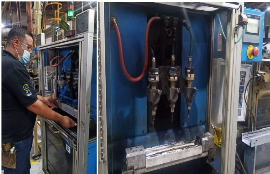
Ilustración 63 Cambio de turbinas y guía en perforadora Cooper Standard. Fuente: Elaboración propia, 2022
