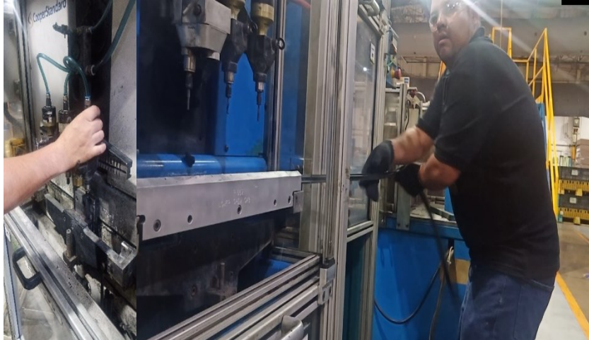
Ilustración 84 Orientar el perfil por barrenadora y encenderla Cooper Standard. Fuente: Elaboración propia, 2022
