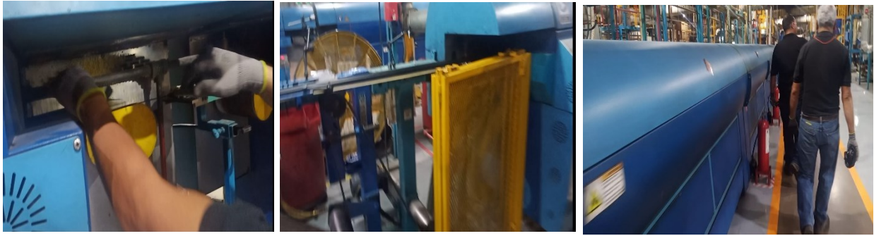
Ilustración 80 Dirigir el perfil en los primeros hornos de la línea Cooper Standard. Fuente: Elaboración propia, 2022
