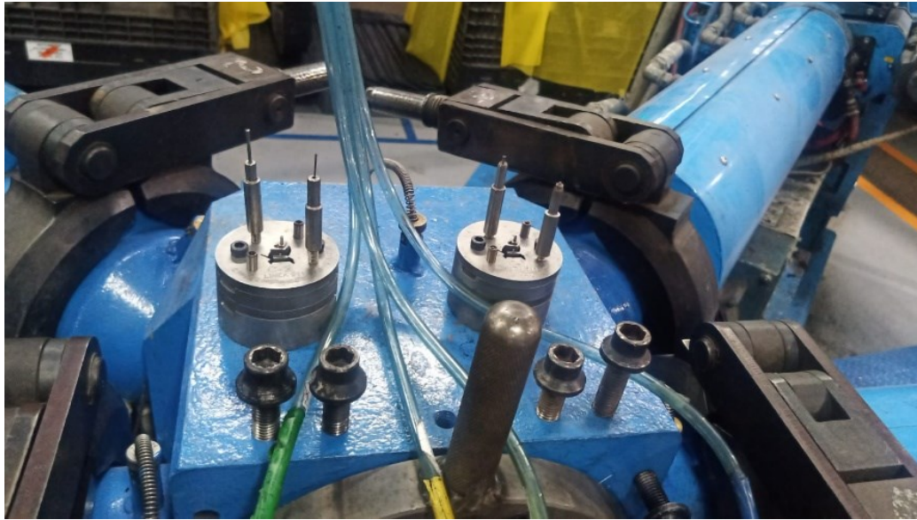
Ilustración 116 Precalentamiento de dados Cooper Standard. Fuente: Elaboración propia, 2022
